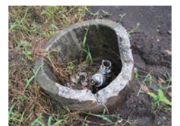
トラクター用モアによる給水栓破損
