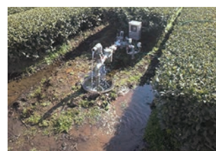
給水栓の破損による漏水
