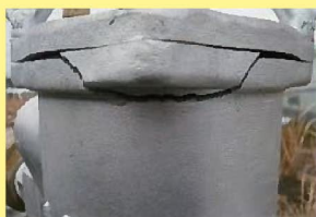
フィルターの破損
