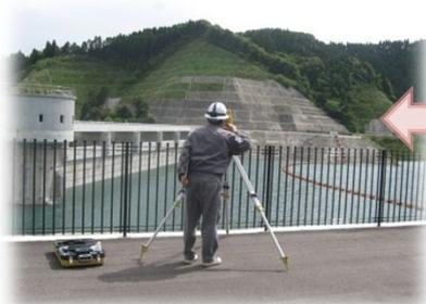
光波による対岸との距離、角度を計測することによってダムの挙動を確認しています。
